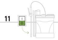
Após utilizar, retire o pulverizador das costas e pouse-o numa superfície plana e estável, coloque o botão de energia na posição "O" (Desligado).
