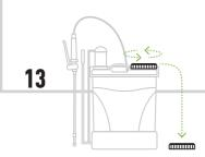
Desaperte e retire a tampa do depósito. Para evitar perder a tampa, quando a retirar, aconselhamos que a coloque junto do pulverizador.
