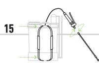
Antes de armazenar, desaperte a cana, a mangueira e retire as alças de transporte para facilitar o encaixe na caixa de cartão.
