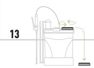
Após despressurizar totalmente o pulverizador, com cuidado, desaperte e retire a tampa do depósito. Coloque a tampa junto do pulverizador.
