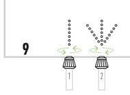
Para ajustar o fluxo de pulverização rode o bico da cana. Rode para a direita para função jato (1), rode para a esquerda para função chuveiro (2).
