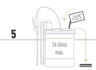
Encha o depósito com o líquido a pulverizar até à marca do nível pretendido. A temperatura do líquido não deve exceder os 25°C.
