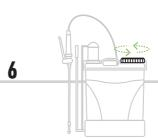
Coloque novamente a tampa do depósito e aperte bem. Verifique sempre se a tampa fica bem instalada para evitar fugas.
