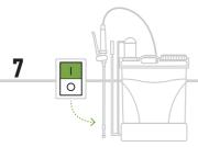
Para que o depósito ganhe pressão, coloque o botão de energia na posição "I" (Ligado). Coloque o pulverizador nas costas e agarre o punho.
