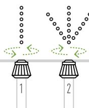
Para ajustar o fluxo de pulverização rode o bico da cana. Rode para a direita para função jato (1), rode para a esquerda para função chuva (2).
