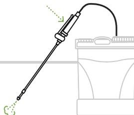
Antes de abrir a tampa do depósito, efetue uma depressurização total, pressione o gatilho até sair toda a pressão do depósito.
