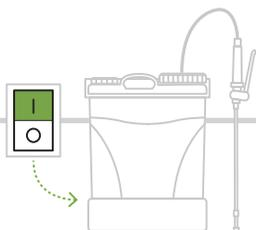
Para que o depósito ganhe pressão, coloque o botão de energia na posição "I" (Ligado). Coloque o pulverizador nas costas e agarre o punho.
