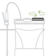
Encha o depósito com o líquido a pulverizar até à marca do nível pretendido. A temperatura do líquido não deve exceder os 25°C.
