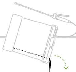
Desaperte e retire a tampa do depósito. Para evitar perder a tampa, quando a retirar, aconselhamos que a coloque junto do pulverizador.
