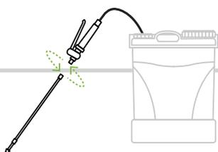
Instale a mangueira e a cana de pulverização, siga as indicações da figura acima representada e certifique-se que ficam bem instaladas.
