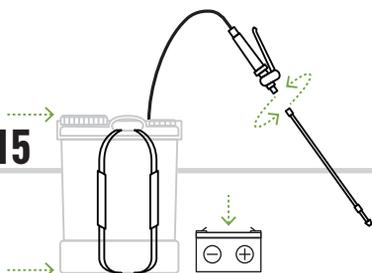
Antes de armazenar, carregue a bateria, desaperte a cana, a mangueira e retire as alças de transporte para facilitar o encaixe na caixa de cartão.
