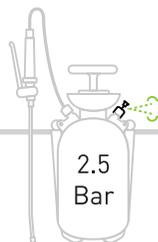
Não exceda o limites do pulverizador, se a pressão exceder o limite máximo (2.5bar) a válvula de segurança poderá abrir.
