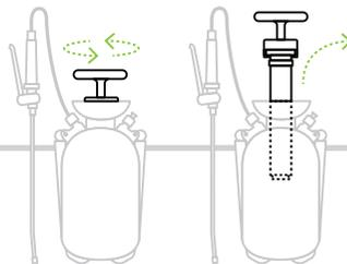
Desaperte a bomba (siga as indicações da figura acima representada) e retire a bomba do pulverizador.
