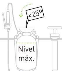
Encha o depósito com o líquido a pulverizar até à marca do nível / limite máximo.
