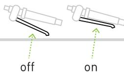
Para pulverizar o líquido armazenado no depósito aperte o gatilho (on), para parar ou reduzir o fluxo solte o gatilho (off).
