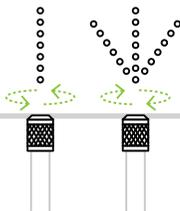
Para ajustar o fluxo da cana de pulverização rode a ponta para a direita (função jato) e para a esquerda (função chuveiro).
