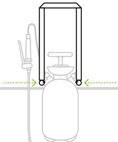
Instale a alça de suporte, encaixe os anéis metálicos nos orifícios do pulverizador.
