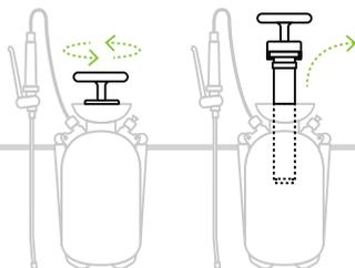
Desaperte a bomba (siga as indicações da figura acima representada) e retire a bomba do pulverizador.
