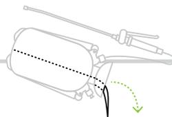
Remova o líquido do depósito, efetue uma limpeza ao pulverizador e aos acessórios (ler pág.4).
