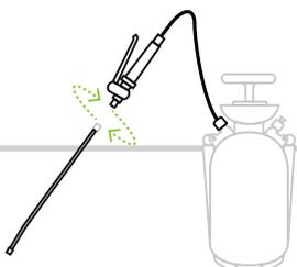
Para armazenar desaperte a cana do punho do pulverizador e retire as alças de suporte para facilitar o encaixe na caixa.
