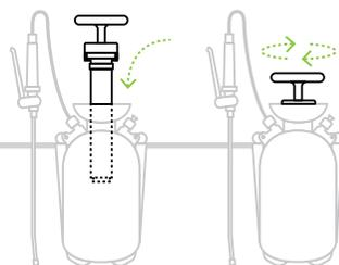
Coloque a bomba no pulverizador (siga as instruções da figura acima representada) e aperte a bomba.
