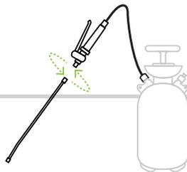
Instale a cana de pulverização, aperte a cana ao punho do pulverizador, certifique-se de que fica bem instalada.
