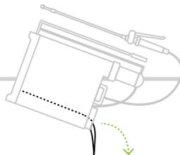
Remova totalmente o líquido contido no depósito. Efetue uma limpeza adequada ao pulverizador e aos seus acessórios (ler pág.4).
