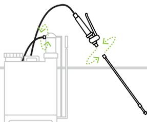
Antes de armazenar, desaperte a cana, a mangueira e retire as alças de transporte para facilitar o encaixe na caixa de cartão.
