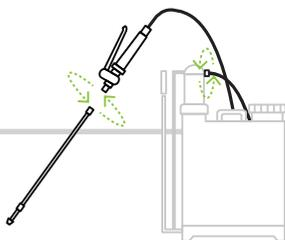
Instale a mangueira e a cana de pulverização, siga as indicações da figura acima representada e certifique-se que ficam bem instaladas.
