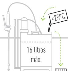
Encha o depósito com o líquido a pulverizar até à marca do nível pretendido. A temperatura do líquido não deve exceder os 25°C.
