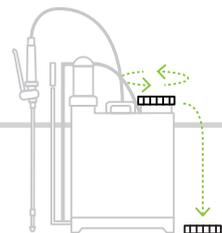
Após despressurizar totalmente o pulverizador, com cuidado, desaperte e retire a tampa do depósito. Coloque a tampa junto do pulverizador.
