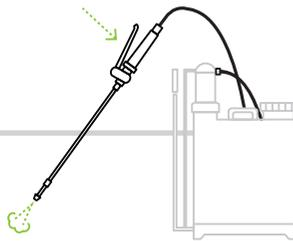
Após utilizar, antes de abrir, despressurize totalmente o pulverizador, pressione o gatilho até sair toda a pressão do depósito.
