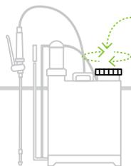
Coloque novamente a tampa do depósito e aperte bem. Verifique sempre se a tampa fica bem instalada para evitar fugas.
